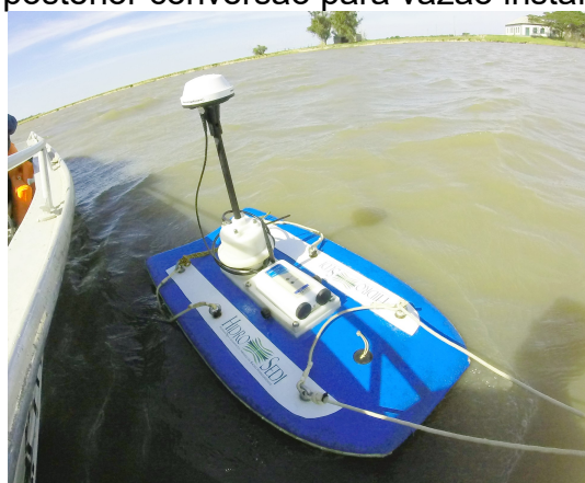
Figura 2 – Perfilador acústico SONTEK M9 acoplado a uma prancha de navegação, rebocada por embarcação.
