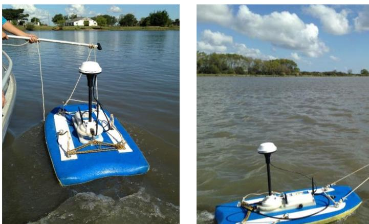
Figura 3 – Perfilador acústico de correntes com efeito doppler M9 acoplado a prancha, em operação num curso d'água.
