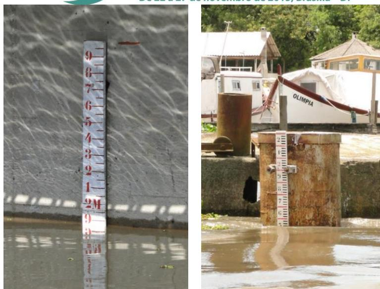
Figura 4 – Régua linimétrica instalada à montante (a) e à jusante (b) da barragem Eclusa, localizada no Porto de Pelotas-RS.
