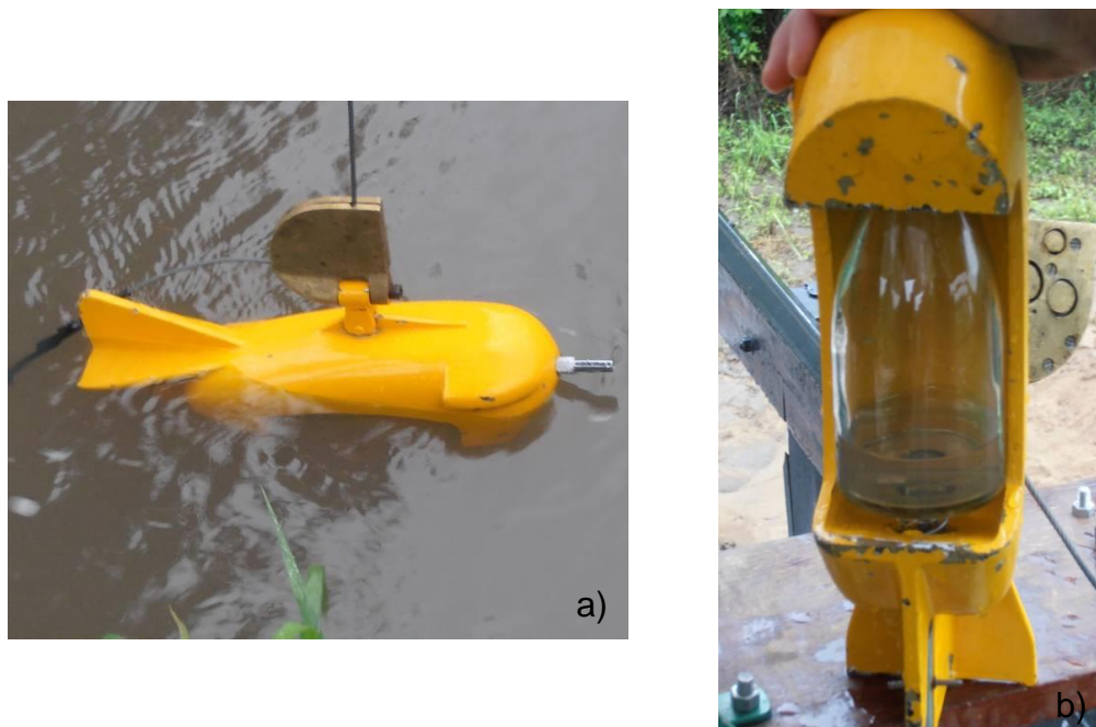
Figura 9 – Amostrador de sedimentos em suspensão do tipo USDH-59 (a) e amostra acondicionada na garrafa (b).
