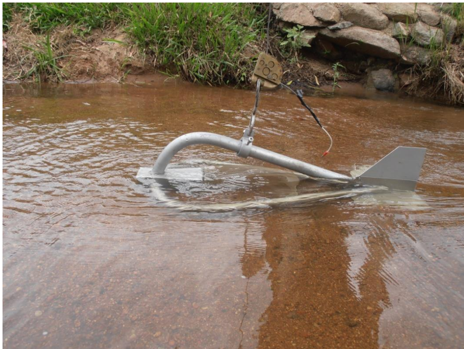
Figura 12 – Amostrador Helley-Smith, utilizado para amostragem de sedimento transportado em arraste.
