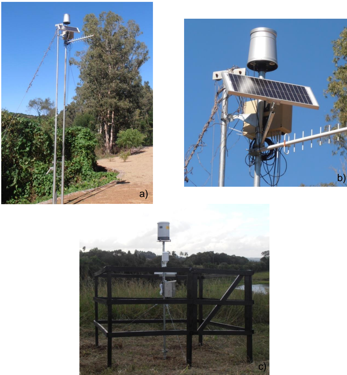
Figura 6 – Imagens representativas do pluviômetro EH-HS03 (a, b) e dos pluviômetros E-01, E-02 e E-03 (c) na Bacia Hidrográfica do Arroio do Ouro.
