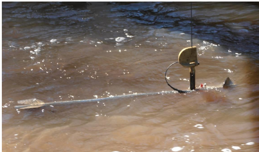
Figura 7 – Molinete OTT C31 na Bacia do Arroio do Ouro.
