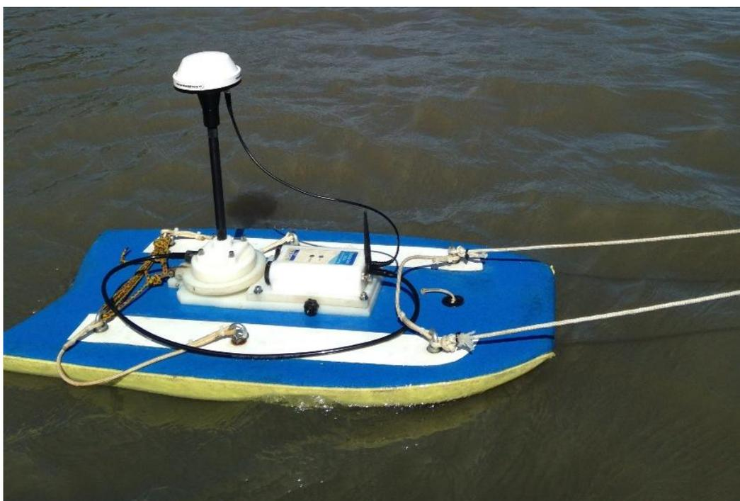
Figura 11: Medidor acústico M9 (ADCP) em operação, instalado sobre prancha. Observa-se além do M9, o GPS e o rádio transmissor.
