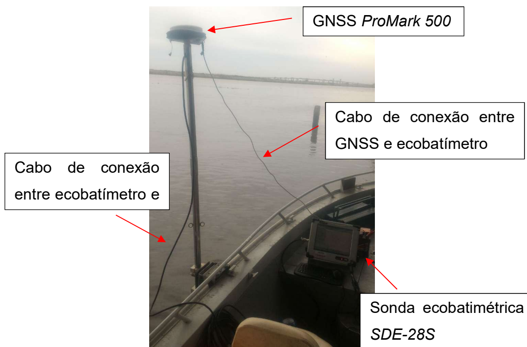
Figura 8 -Esquema de instalação dos equipamentos na embarcação.
