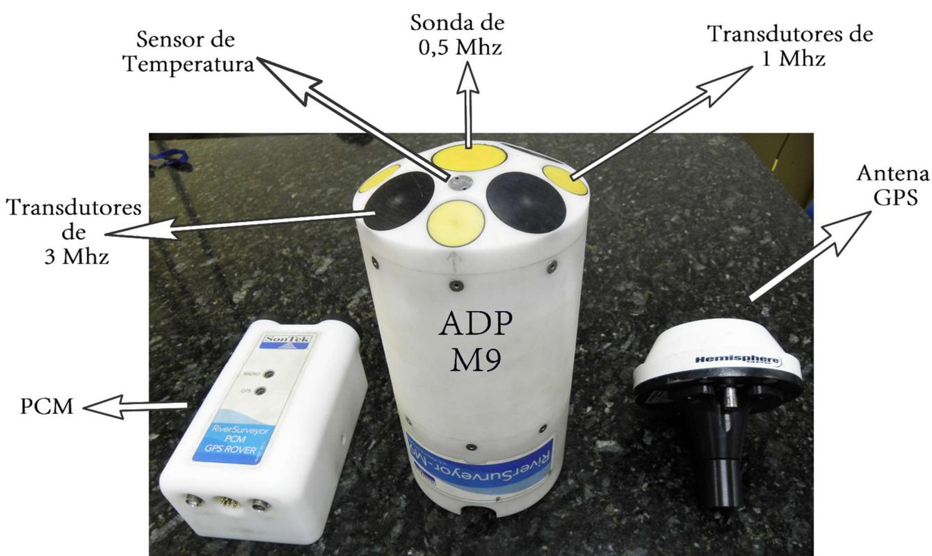
Figura 12 – Perfilador acústico móvel M9 – SONTEK acompanhado do Módulo de Comunicação e Energia (PCM) e a antena GPS.
