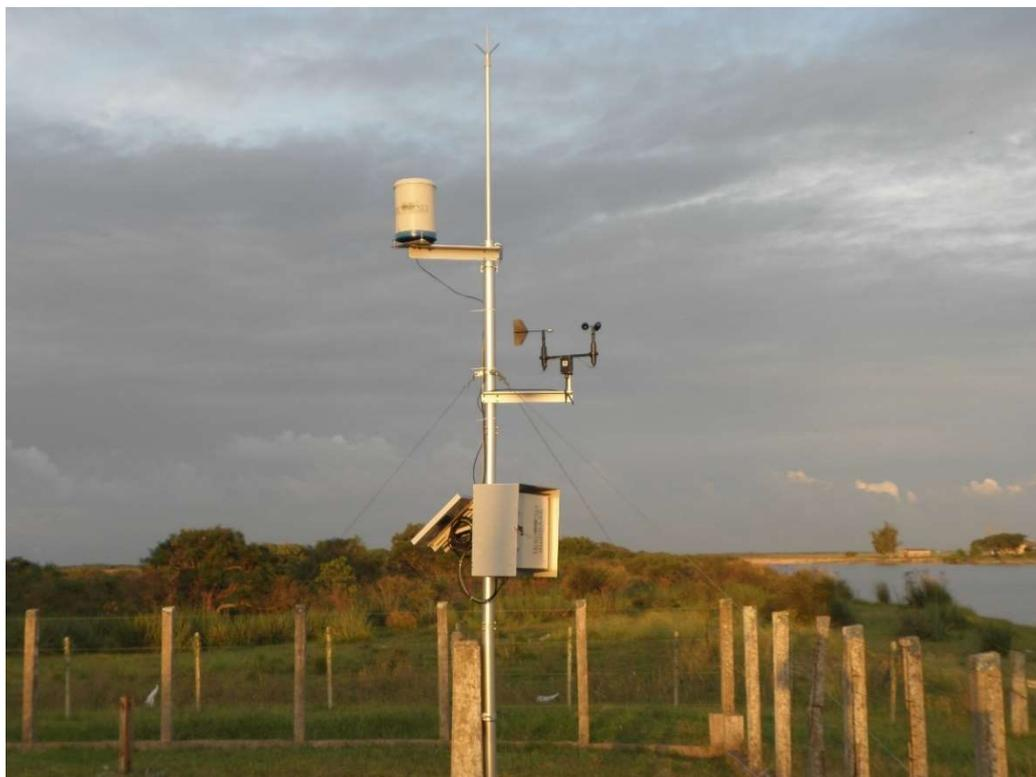
Figura 15 - Estação hidrometeorológica localizada ao lado do posto fluviométrico.
