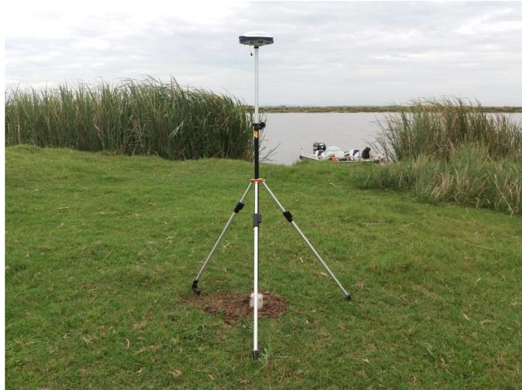
Figura 5: Rastreamento marco com GNSS.
