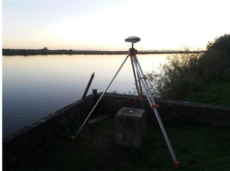
Figura 7: Base de referência para ajustamento dos pontos.
