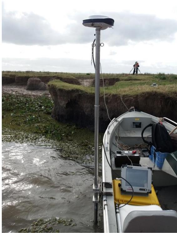
Figura 2: Conjunto equipamento para levantamento batimétrico.
