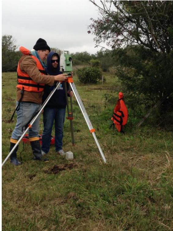
Figura 9: Instalação da estação total sobre marco.
