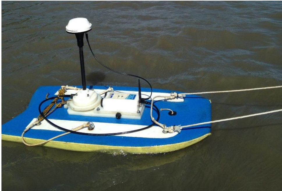
Figura 2 - Equipamento móvel (M9) em operação na prancha puxada por uma embarcação. Fonte: Laboratório de Hidrometria da Universidade Federal de Pelotas
