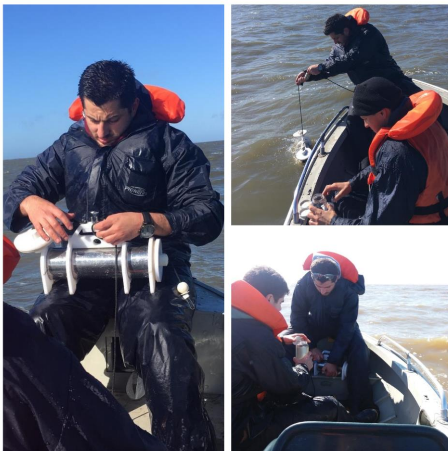
Figura 5- Amostragem do Sedimento em suspensão com garrafa de Van Dorn.
