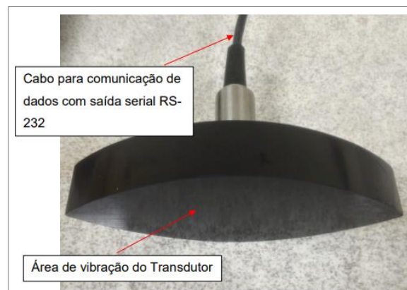
Figura 4: Transdutor utilizado com o ecobatímetro. Fonte: GONÇALVES, 2017.
