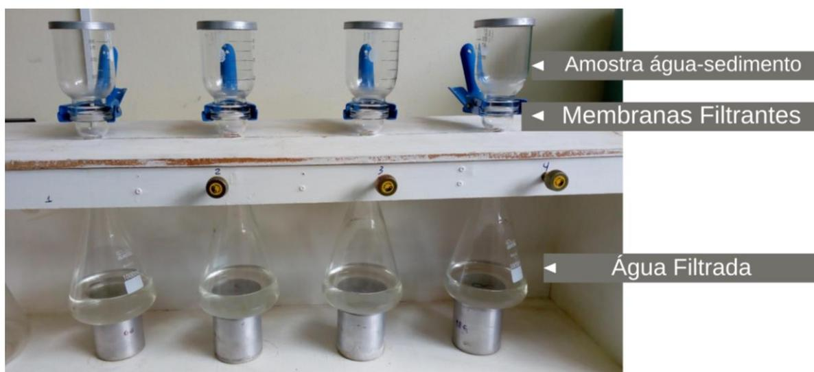
Figura 20 – Sistema montado para execução do método de filtração das amostras. Fonte: Próprio autor.
