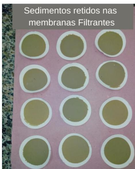
Figura 21 – Membranas filtrantes e as partículas sólidas retidas. Fonte: Próprio autor.
