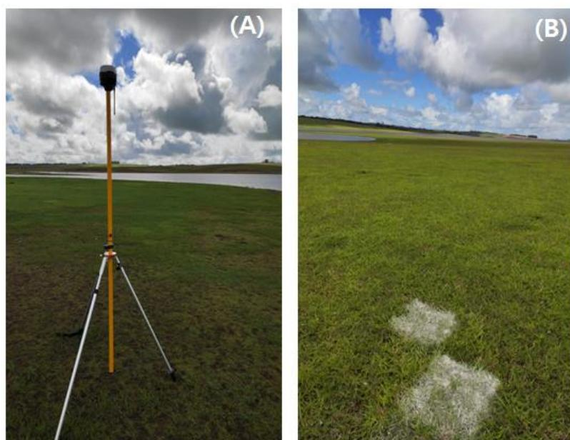
Figura 12 – (A) Equipamento utilizado para levantamento dos pontos de controle e (B) alvo foto-identificável instalado.
