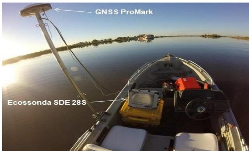
Figura 9 - Conjunto dos equipamentos utilizados para levantamento batimétrico.
